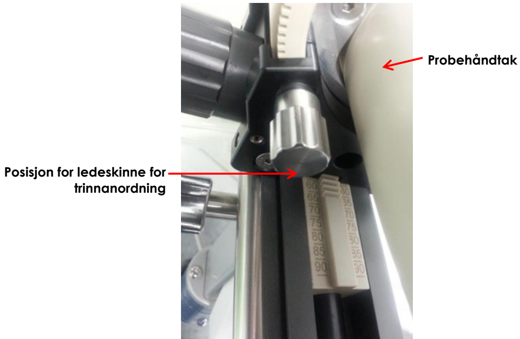
Figur 40: Posisjon for ledeskinne for trinnanordning
