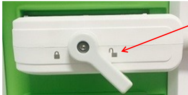
Figur 29: Låseknot for probetilkobling i ulåst posisjon
